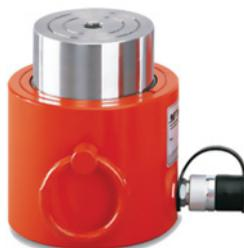
Односторонние домкраты с пружинным возвратом от 10 до 100 т, рабочее давление 700 бар. Компактные гидроцилиндры с низкой конструктивной высотой для подъёма тяжёлых грузов или рихтовки в ограниченном пространстве.
