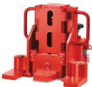
Грузоподъёмность 3–25 т. Давление 520 бар. Для подъёма станков и подобных больших грузов. Насос встроен, рычаг в комплекте. Угол движения рычага 270 градусов. Грузоподъёмность одинаковая на верхней площадке и на подхвате. Стальная конструкция корпуса домкрата устойчива и не подвержена возможным при подъёме станков боковым усилиям. Поворотные опорные детали обеспечивают наилучшее распределение нагрузки на пол.
