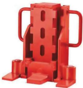
Грузоподъёмность 4,5–50 т, давление 700 бар. Эти домкраты разработаны для подъёма и установки станков и подобных тяжёлых грузов. Стальная конструкция корпуса домкрата устойчива и не подвержена возможным при подъёме станков боковым усилиям. Поворотные опорные детали обеспечивают наилучшее распределение нагрузки на пол. Подхват переставляется по высоте. Груз можно поднимать как на верхней площадке, так и на подхвате. Домкрат поставляется заполненным маслом.
