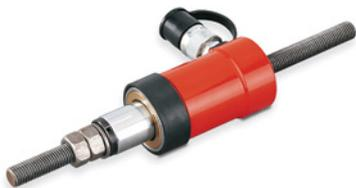
Односторонние домкраты с пружинным возвратом от 12 до 93 т, рабочее давление 700 бар. Эти цилиндры имеют сквозное резьбовое отверстие в штоке для крепления к резьбовым стержням, что позволяет использовать их для предварительного натяжения болтов, для завинчивания гаек без трения, для снятия осей, валов, подшипников и других операций, требующих мощного тягового усилия.
